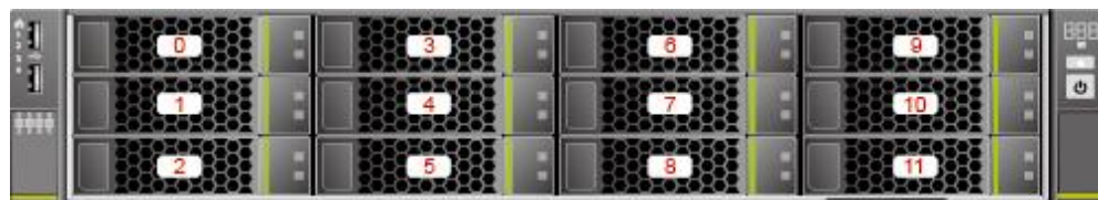
Abbild 3-20 Steckplätze der vorderen Festplatten
