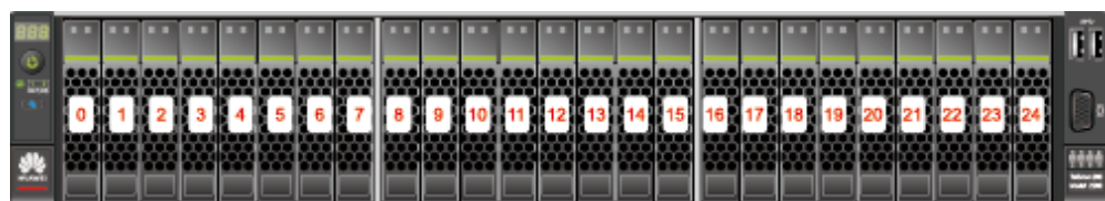
Abbild 3-4 Steckplätze der vorderen Festplatten
