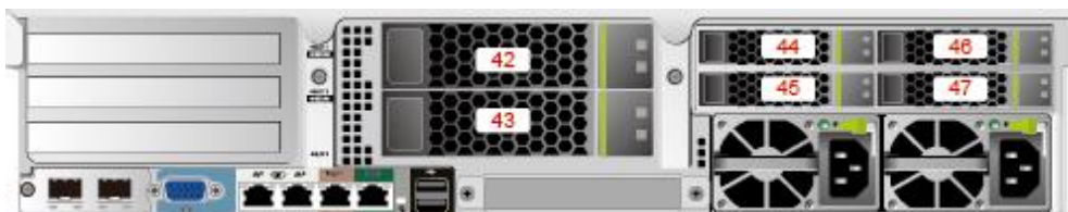
Abbild 3-24 Steckplätze der hinteren Festplatten
