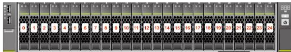
Abbild 3-22 Steckplätze der vorderen Festplatten
