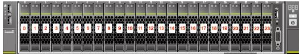
Abbild 3-35 Steckplätze der vorderen Festplatten
