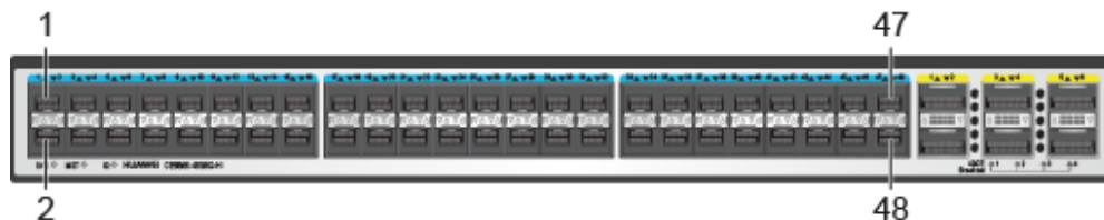
Abbild 3-63 Optischer 10GE-/25GE-SFP28-Ethernet-Port
