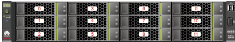
Abbild 3-2 Steckplätze der vorderen Festplatten
