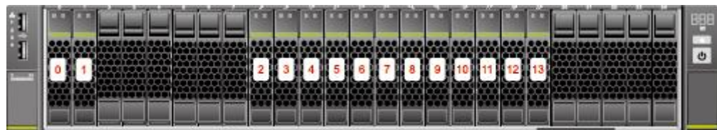
Abbild 3-33 Steckplätze der vorderen Festplatten
