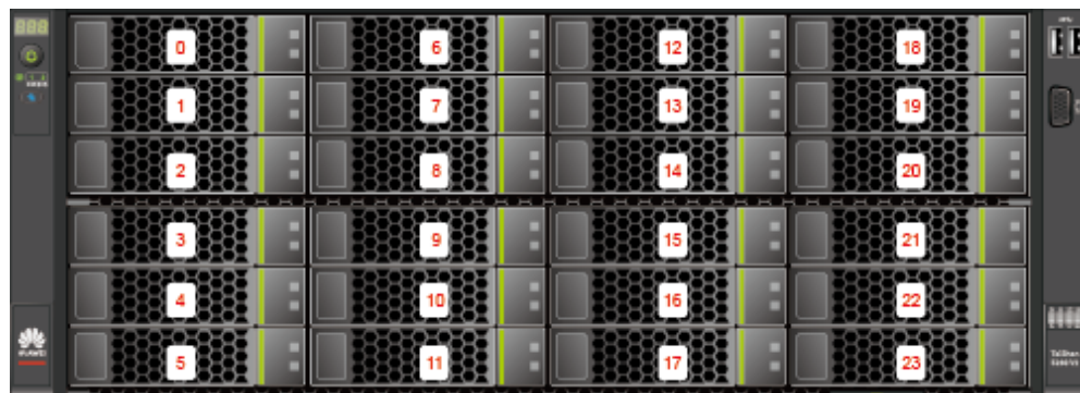
Abbild 3-11 Steckplätze der vorderen Festplatten
