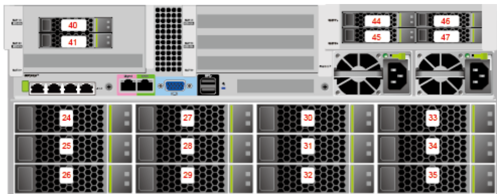
Abbild 3-13 Steckplätze der hinteren Festplatten
