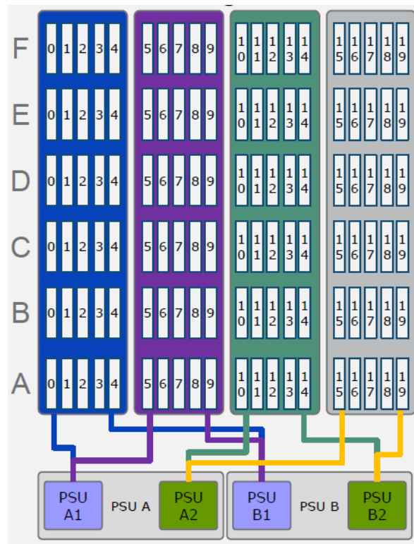
Abbildung 2. DAE-Anordnung im Brick der VMAX 450F/850F – Laufwerkssteckplätze und Stromversorgungsbereiche
