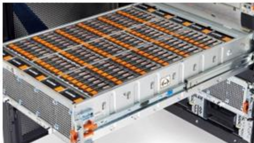
Abbildung 3. Voll bestücktes Brick-DAE der VMAX 450F/850F
